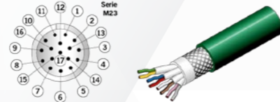
VISTA LATO SALDATURA
